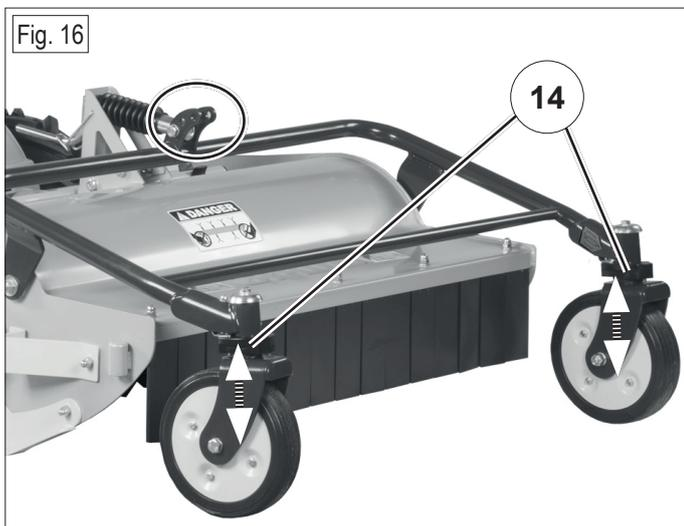
La manovella di regolazione ha un meccanismo incernierato ad un determinato foro con un dado e una vite (fig.16), i due fori liberi servono
