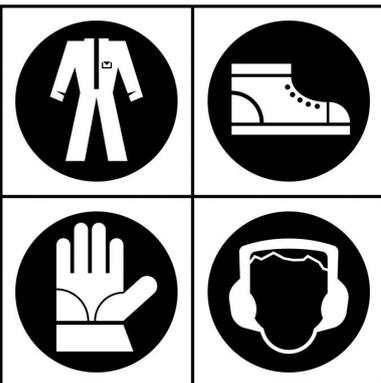
Prima di utilizzare la macchina, è necessario indossare gli appositi dispositivi di sicurezza individuali: protezione del corpo, guanti di protezione, calzature di sicurezza, protezione dell'udito, occhiali.
