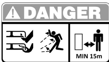
Non mettere mani o piedi sotto o nel rasaerba quando il motore è in moto. Non lavorare col rasaerba su ghiaia o corpi estranei che possono essere aspirati e centrifugati dalle lame, risultando molto pericolosi. Tenere lontano le persone ad almeno 15 m quando la macchina è in funzione.
