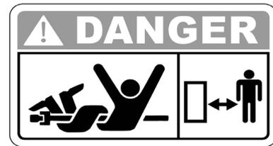
Non toccare il giunto cardanico in rotazione, può arrecare gravi danni alla persona. Non fare manutenzione col motore in moto.
