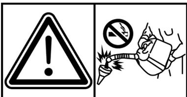
Maneggiare il carburante con cura, poiché è altamente infiammabile; non fare rifornimento mentre si fuma, vicino a fiamme libere o scintille, quando il motore è acceso.
