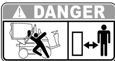
Il cesto di raccolta erba può essere alzato e ribaltato, mantenersi a debita distanza dalla macchina in funzione.
