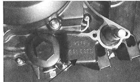
**NOTA:** il numero di identificazione del veicolo viene usato per identificare il vostro ATV. L'informazione relativa al numero di identificazione del veicolo e del motore saranno necessarie per ordinare le parti di ricambio al vostro rivenditore.
