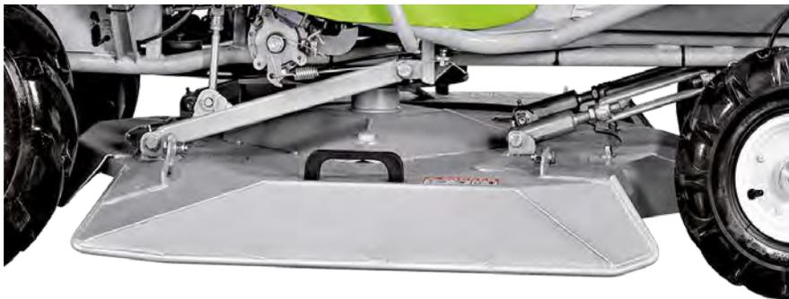
**Lama di taglio in acciaio speciale** con terminali oscillanti a doppio tagliente: si può sfruttare al massimo la durata capovolgendo la lametta una volta usurato il primo tagliente. La lama ha una speciale forma a basso assorbimento di potenza e ridotta rumorosità.
