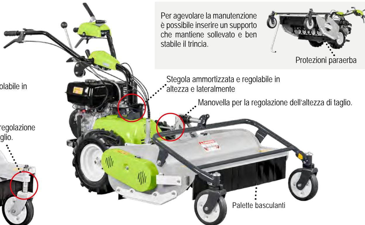
GH 9 con motore GX 270 e trincia da cm 85
