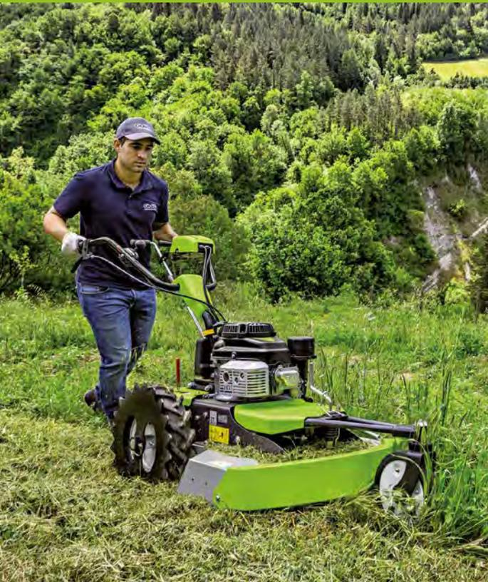
CL 62M monta un motore OHV monocilindrico, cilindrata di 179 cc 4.5 HP a benzina con serbatoio da 1,6 L con **sistema di lubrificazione forzata che consente un utilizzo della macchina fino a pendenze di 30°.**
