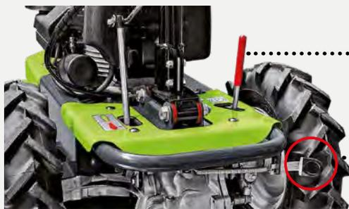
Il trinciaerba dispone di un **freno di stazionamento a disco** capace di mantenere ferma la macchina anche in pendenza.
