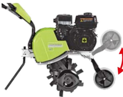
**La fresa standard** è larga 83 cm e consente una profondità di fresatura fino a 32 cm. È costituita da 6 stelle di zappe con dischi laterali ed è saldamente bloccata sull'asse fresa con bulloni M10.
