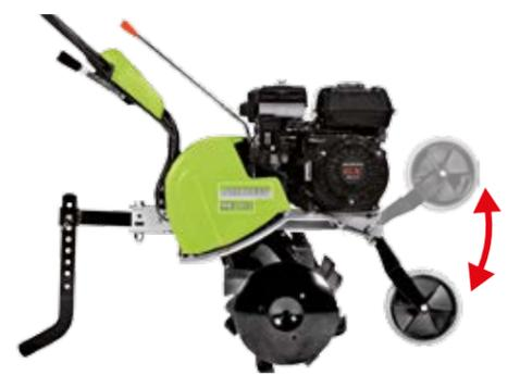
**La fresa standard** è larga 97 cm e consente una profondità di fresatura fino a 33 cm. È costituita da 6 stelle di zappe con dischi laterali. Le zappe realizzate in acciaio temprato sono fissate tramite bulloni.
